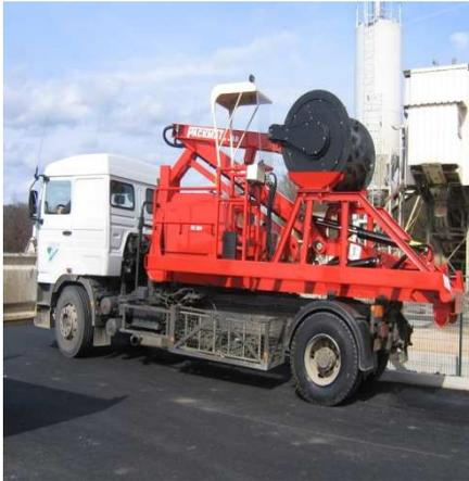
Le SIRTOM s'est doté d'un compacteur à rouleau appelé « **PACK MAT** » équipé d'un rouleau de 2000 kg motorisé. Embarqué sur un camion, il se déplace de déchetterie en déchetterie afin d'assurer le compactage des déchets.
